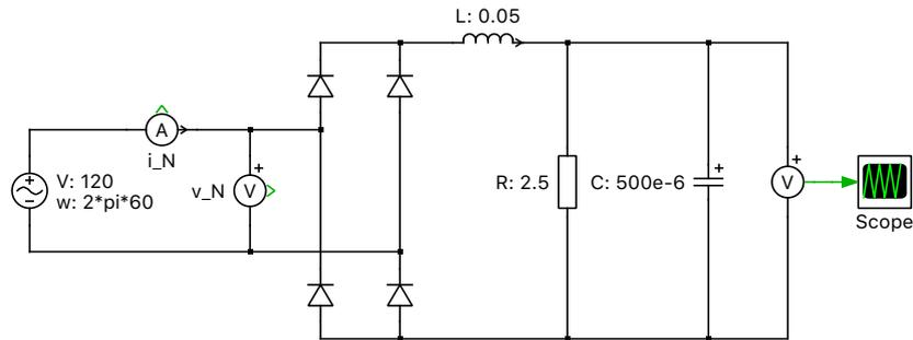
**Figure 1: Diode rectifier**
